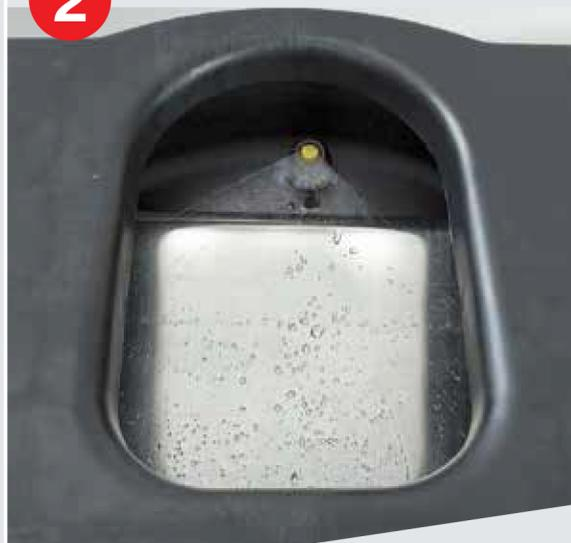
La nuova vasca garantisce la copertura totale del vano reflui e un maggiore igienizzazione grazie al sistema di pulizia a nastro rotante e rasatore in acciaio inox.
